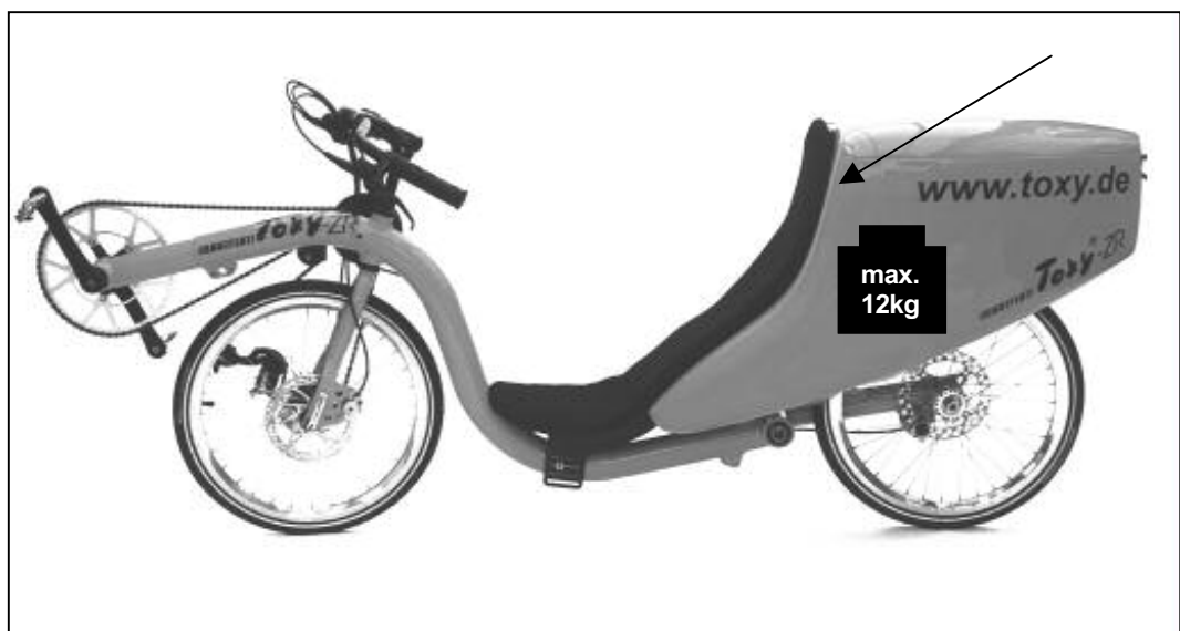
Aerodynamischer Heckkoffer des Toxy-ZR, neu jetzt auch mit Aero-Head-Top (o. Abb.)
