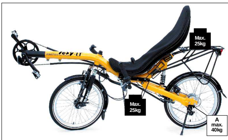
Gepäcktransport und Anhänger-Befestigung am Toxy. Das zulässige Gesamtgewicht beträgt 150, bei Faltrahmen 125kg
